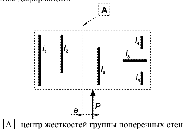
Рисунок I.3 – Эксцентриситет нагрузки относительно центра жесткостей группы поперечных стен
